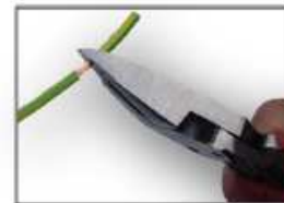
Abisolieren Stripping 1,5 + 2,5 mm 2
