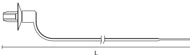
90°-Geometrie für besseren Sitz auf dem Bündelgut: T50MD7
