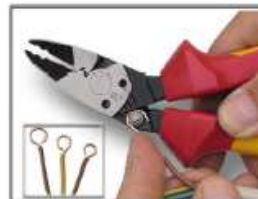
Ösen biegen Looping device Ø 4, 5, 6 mm
