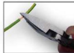
Abisolieren Stripping 1,5 + 2,5 mm 2
