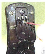
4. Der Crimpvorgang wird ausgeführt, indem Sie die Werkzeuggriffe vorsichtig zusammendrücken. Sobald die Crimpbacken vollständig ineinander fassen, wird die Ratsche automatisch gelöst und das Kabel mit dem angecrimpnten Kabelschuh kann entnommen werden.
