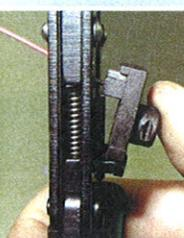
6. Falls das Werkzeug vor der Durchführung des Crimpvorganges aufgrund einer falschen Kabelschuh-Positionierung geöffnet werden muss, kann die Ratsche gelöst werden, indem Sie gegen den Freigabehebel drücken.
