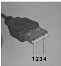
Abb. 002: USB-Anschlusskabel, Anschlussbelegung des Steckers: 1) = -5 V, 2) = D+, 3) = D-, 4) = +5 V
