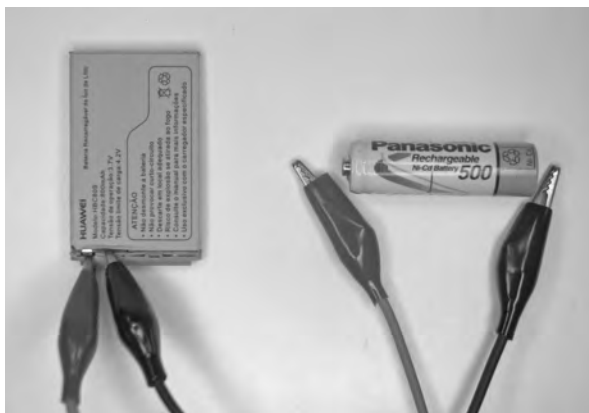
Abb. 065: Anwendung mit Lithium-Akku und Krokodilkabel
