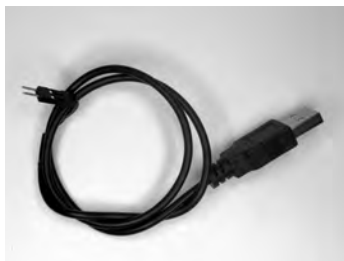
Abb. 002: USB-Anschlusskabel, Anschlussbelegung des Steckers: 1) = -5 V, 2) = D+, 3) = D-, 4) = +5 V
