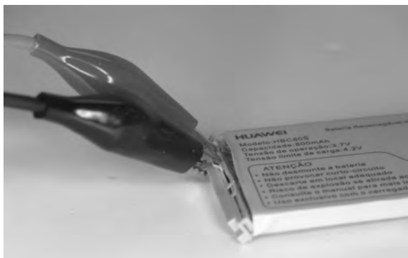
Abb. 039: Klemmverbindung mit den Akkukontakten
