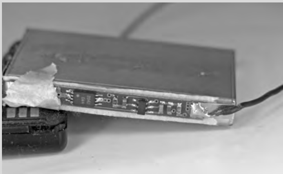
Abb. 038: Geeigneter Akku mit integrierter Sicherheits-/Schutzelektronik
