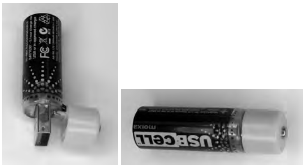
Abb. 022: USB-Cell-NiMH, Mignonzelle mit eingebautem USB-Adapter
