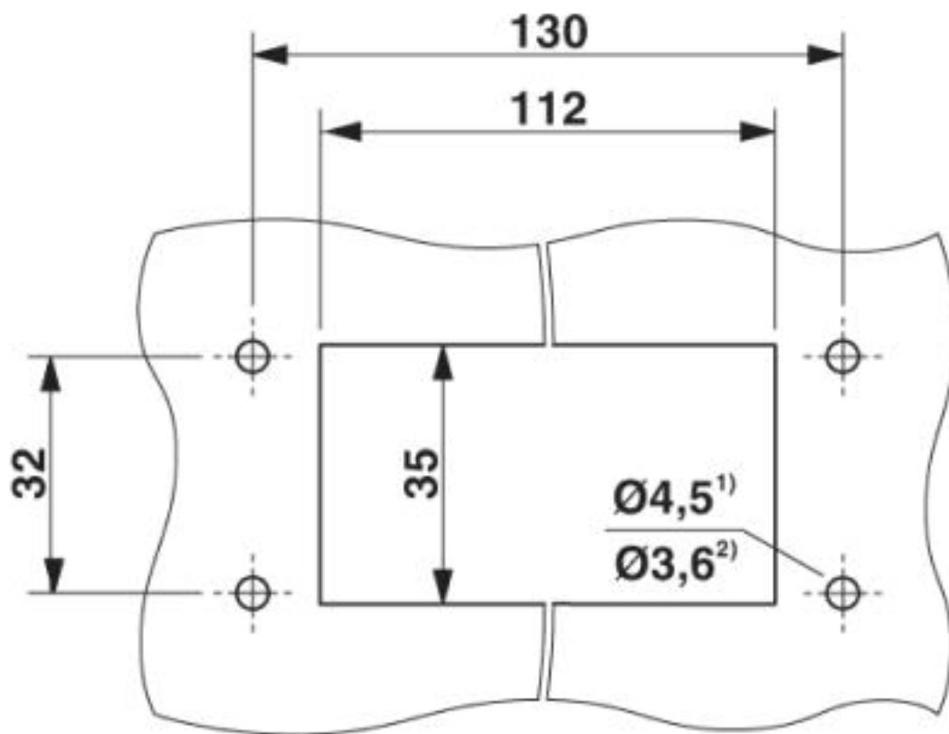
Montageausschnitt<sup>2)</sup> bei Einsatz von selbstfurchenden Schrauben
