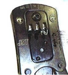
2. Kabelschuh in die richtige Lage innerhalb der Quetschbacken gebracht wird. Isolieren Sie nun ein Kabel in der empfohlenen Länge ab.
