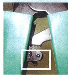
Falls das Werkzeug vor der Durchführung des Crimpvorganges aufgrund einer falschen Kabelschuh-Positionierung geöffnet werden muss, kann die Ratsche gelöst werden, indem Sie gegen den Freigabehebel drücken.
