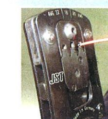
Der Crimpvorgang wird ausgeführt, indem Sie die Werkzeuggriffe vorsichtig zusammendrücken. Sobald die Crimpbacken vollständig
