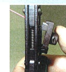
Bei der Entnahme des fertigen Kabels ist die Positioniereinrichtung etwas nach vorne zu ziehen, so dass sich das Kabel leichter entnehmen lässt.
