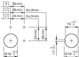
L1 = Löt-/Steckanschluss 2.8 x 0.5 mm
