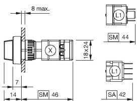
L1 = Löt-/Steckanschluss 2.8 x 0.5 mm
