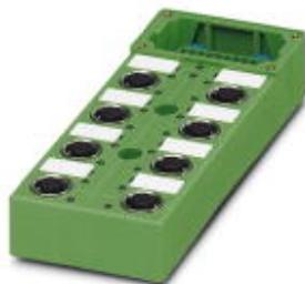
Sensor-/Aktor-Box-Grundgehäuse, Anschlussart: M12-SPEEDCON-Buchse Metall, Anzahl der Steckplätze: 8, Polzahl: 5, Steckplatzbelegung: doppelt, Statusanzeige: Ja, pnp; Stammleitungsanschluss: Steckbarer Schraubanschluss, Schirmung: nein
