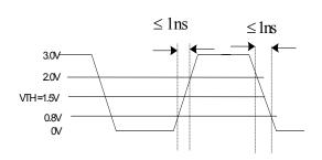
3.3V LVTTL INPUT TEST WAVEFORM
