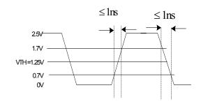
25V LVTTL INPUT TEST WAVEFORM
