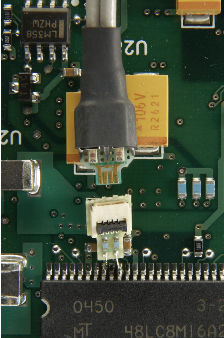
InfiniiMax ZIF tip soldered on board
