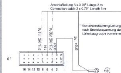
Abb. 4.6 Anschlußbelegung Führungsrahmen SK 3357 100, SK 3358 100 für Einschublüfter Vario
