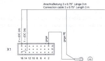
Abb. 4.6 Anschlußbelegung Führungsrahmen SK 3357 100, SK 3358 100 für Einschublüfter Vario
