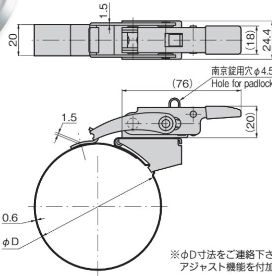
※ $\phi D$ 寸法をご連絡下さい。(最少直径は $\phi 50$ です。) $\phi 100$ 以上はファスナーに
