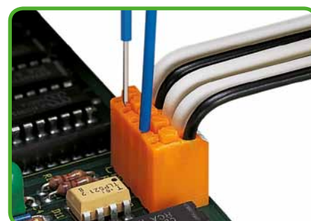
Prüfen mit Prüfstift Ø 1 mm.
