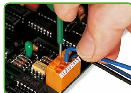
Leiter mittels mit Betätigungsdrücker lösen.
