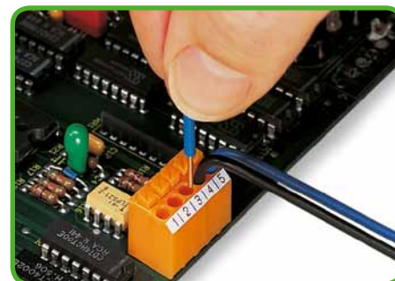
Eindrängige Leiter anschließen – direkt stecken.
