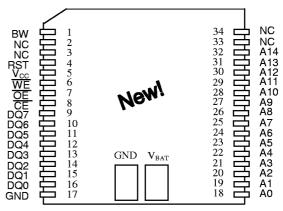
34-Pin POWERCAP MODULE (PCM) (USES DS9034PC POWERCAP)
