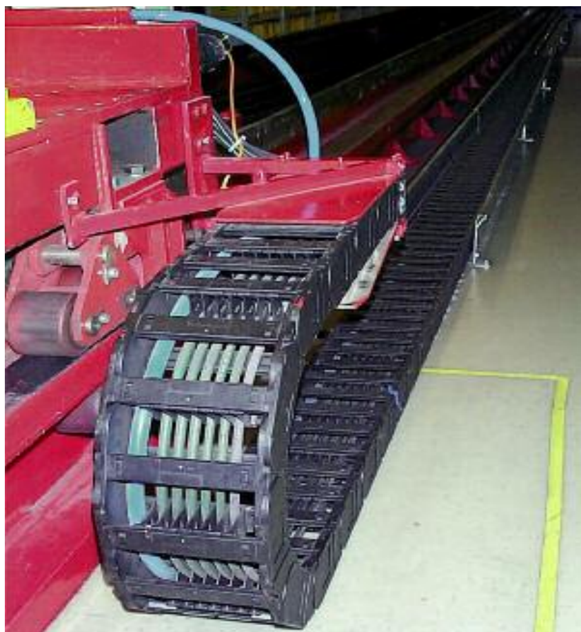
Chainflex® CF5/CF6 in Regalbediengerät: langer Fahrweg in Längsachse. E-Kette®: Serie E4/00 mit igus® Führungsrinne aus Stahl
