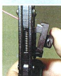
6. Falls das Werkzeug vor der Durchführung des Crimpvorganges aufgrund einer falschen Kabelschuh-Positionierung geöffnet werden muss, kann die Ratsche gelöst werden, indem Sie gegen den Freigabehebel drücken.
