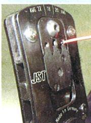
5. Bei der Entnahme des fertigen Kabels ist die Positioniereinrichtung etwas nach vorne zu ziehen, so dass sich das Kabel leichter entnehmen lässt.
