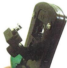
1. Rolle ist zuerst ein Kabelschuh von der Rolle zu trennen und dann in die entsprechende Öffnung der Positioniereinrichtung einzusetzen. Bei der Verwendung von losen Kabelschuhen gilt die Vorgehensweise ebenfalls; ein Abtrennen von der Rolle ist dann nicht erforderlich.
