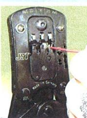
4. Der Crimpvorgang wird ausgeführt, indem Sie die Werkzeuggriffe vorsichtig zusammendrücken. Sobald die Crimpbacken vollständig ineinander fassen, wird die Ratsche automatisch gelöst und das Kabel mit dem angeschraubten Kabelschuh kann entnommen werden.
