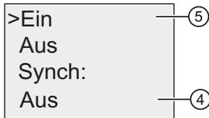
Die aktuelle Einstellung der automatischen Synchronisation wird in der untersten Zeile angezeigt. Die Einstellung im Auslieferungszustand ist "④", d. h. ausgeschaltet.
