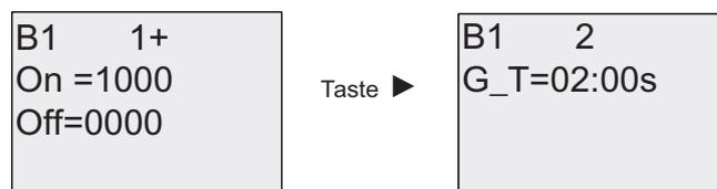
3. Starten Sie danach das Schaltprogramm und schalten Sie LOGO! in den Parametriermodus. Im Parametriermodus sehen Sie sich die Parameter des Schwellwertschalters an.
