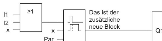
Aus dem ersten Schaltprogramm finden Sie den OR-Block und das Ausgangs-Relais Q1 wieder. Neu ist nur die Ausschaltverzögerung.
