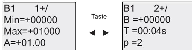
Mit den Tasten ◀ und ▶ navigieren Sie zu den Parametern Min, Max, A, B, T und P. Für jede Ziffer eines Werts blättern Sie mit den Tasten ▲ und ▼ durch die möglichen Werte. Mit der Taste ▶ navigieren Sie von der letzten Zeile des ersten Bildschirms zum zweiten Bildschirm, und mit der Taste ◀ navigieren Sie von der obersten Zeile des zweiten Bildschirms zum ersten Bildschirm. Mit OK übernehmen Sie Änderungen.
