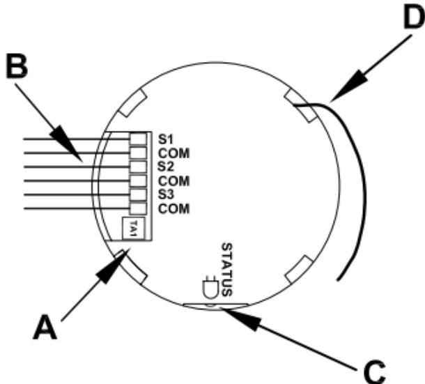
Um die Schließerkontakte Schnittstelle in den Anlernmodus zu bringen, drücken Sie die Anlerntaste (A) kurz. Danach befindet sich die Schließerkontakte Schnittstelle für 20 Sekunden im Konfigurationsmo-
