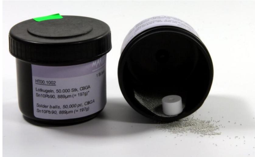
**Lotkugeln höchster Qualität ermöglichen zuverlässige Reballing Ergebnisse. Die Lotkugeln werden in Mengen zu 50.000 St. unter Argon Gas verpackt ausgeliefert. Die Verpackung unter trockenem Argon Gas verhindert ungewünschte Oxidation der Lotkugeln während der Lagerzeit. Oxidierte Lotkugeln haben ein schlechteres Benetzungsverhalten auf den Kontaktflächen und bilden mehr und größere Voids in den umgeschmolzenen Lotballs aus. Die Dosen sind per Schraubdeckel praktisch wiederverschließbar.**
