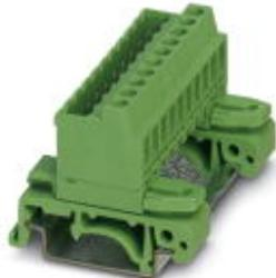
Steckerteil, Nennstrom: 12 A, Bemessungsspannung (III/2): 320 V, Polzahl: 15, Rastermaß: 5,08 mm, Anschlussart: Schraubanschluss, Farbe: grün, Kontaktobерfläche: Zinn, Montage: Tragschiene
