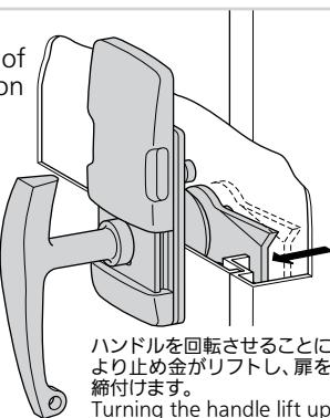
ハンドルを回転させることにより止め金がリフトし、扉を締め付けます。
