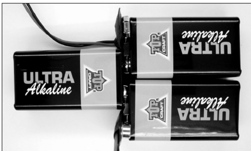
Slika 10.3: Zaporedna vezava treh 9 V blok baterij
