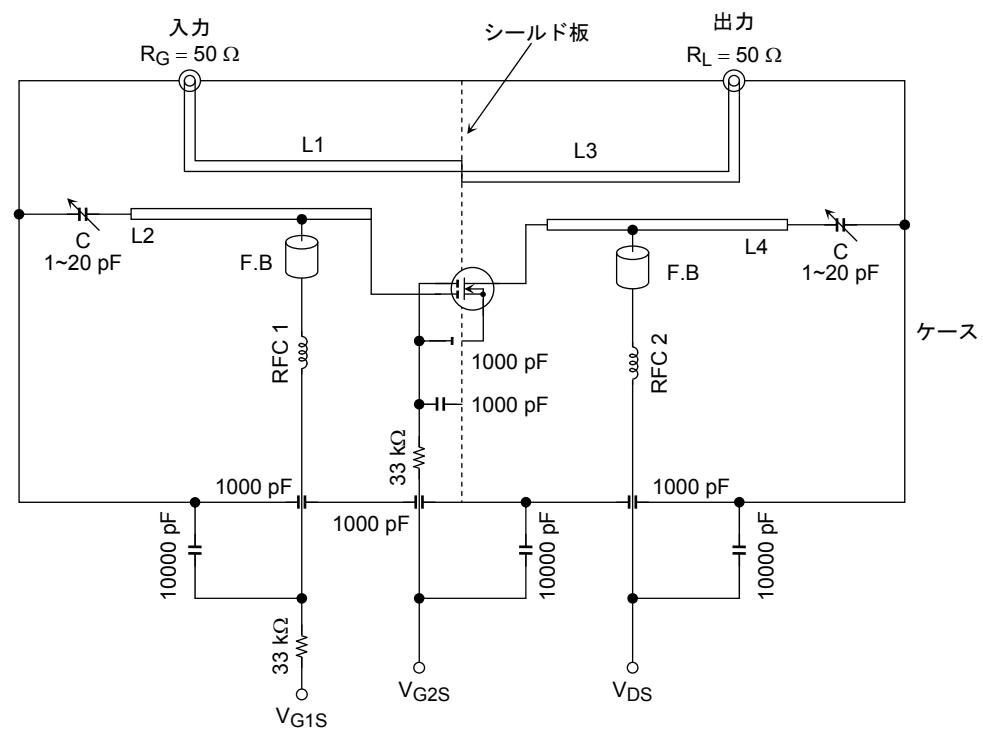
図 1 電力利得および雑音指数測定回路
