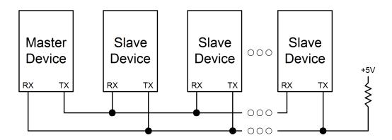
Figure 21.7. UART Multi-Processor Mode Interconnect Diagram
