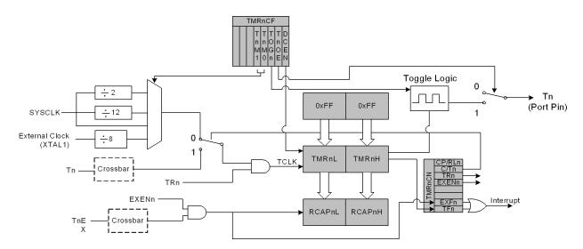
Figure 23.4. Tn Capture Mode Block Diagram
