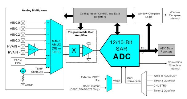
Figure 1.12. 10/12-Bit ADC Block Diagram
