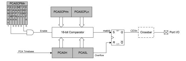
Figure 24.9. PCA 16-Bit PWM Mode
