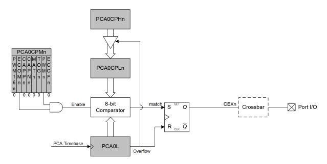
Figure 24.8. PCA 8-Bit PWM Mode Diagram
