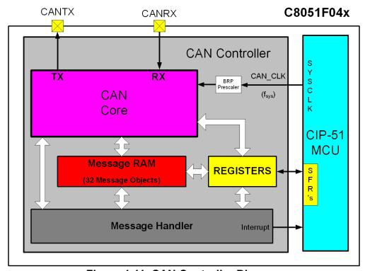
Figure 1.11. CAN Controller Diagram
