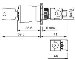
L1 = Löt-/Steckanschluss 2.8 x 0.5 mm
