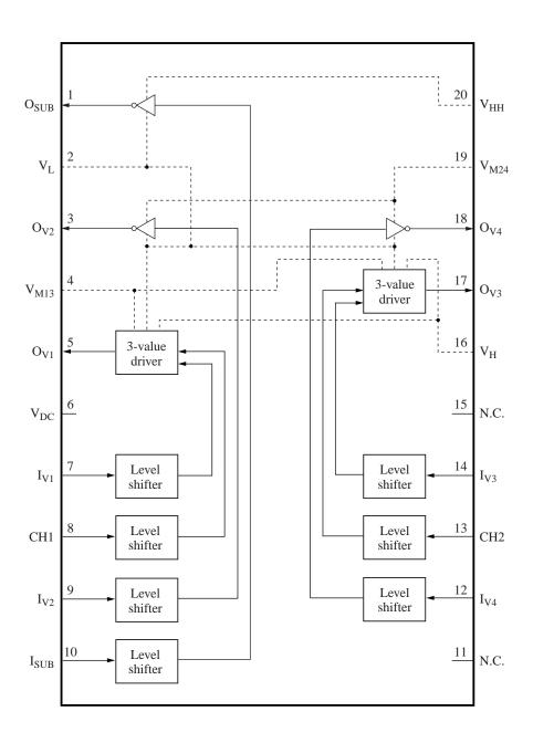
Note)  $V_{DC}$ ,  $V_L$ : Common power supply
