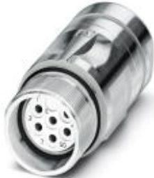
Kupplungssteckverbinder, gerade, geschirmt: ja, SPEEDCON-Verriegelung, M23, Polzahl: 7, Kontaktart: Buchse, Crimpanschluss, Kabeldurchmesser: 3 mm ... 14,5 mm
