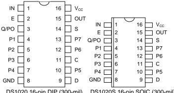
DS1020 16-pin DIP (300-mil) See Mech. Drawings Section
