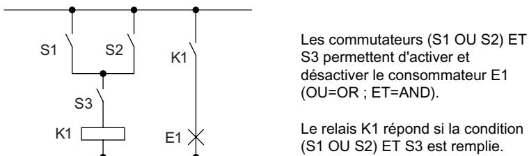
Les commutateurs (S1 OU S2) ET S3 permettent d'activer et désactiver le consommateur E1 (OU=OR ; ET=AND).
