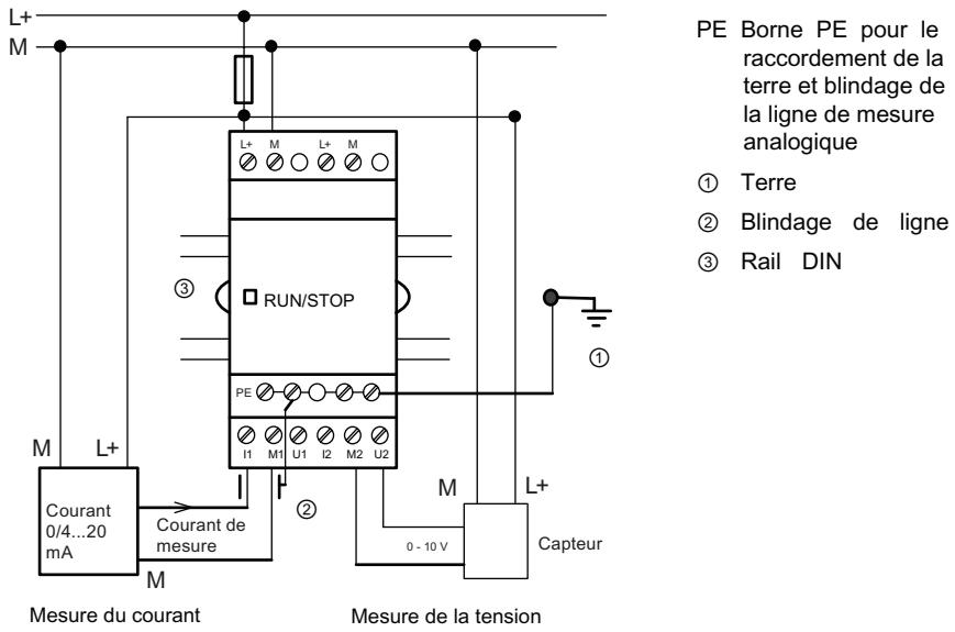
La figure précédente montre un exemple de mesure de courant à 4 fils et de mesure de tension à 2 fils.
