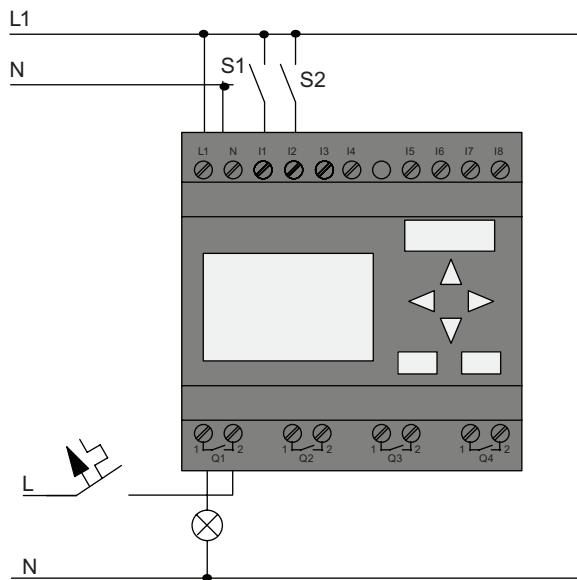
Le commutateur S1 agit sur l'entrée I1 et le commutateur S2 sur l'entrée I2. Le récepteur est connecté au relais Q1.
