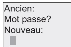
4. Entrez un mot de passe. La procédure de saisie du mot de passe est identique à celle pour le programme de commande. (voir la rubrique Mot de passe pour la protection du programme de commande (Page 94)).
