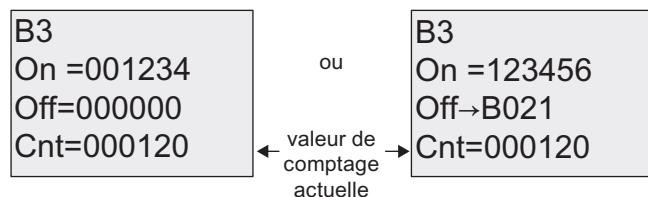
Vous pouvez modifier le seuil d'enclenchement et de déclenchement (On, Off). Cette action est impossible lorsque le seuil d'enclenchement ou de déclenchement est le résultat d'une autre fonction (B021, dans la rubrique "Compteur/décompteur (Page 205)").
