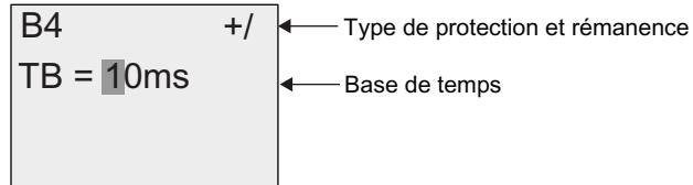
Pour changer la base de temps, appuyez sur ► et déplacez le curseur vers "1". Appuyez sur ▲ ou ▼ pour sélectionner une autre base de temps. Pour confirmer la sélection, appuyez sur OK.
