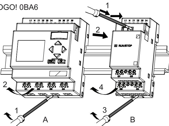
..... dans le cas où au moins un module d'extension est raccordé au module LOGO! Base :
