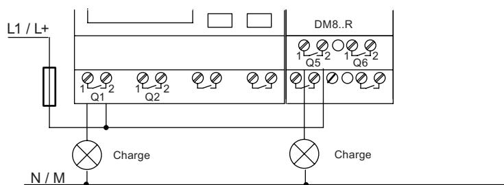
Protection avec disjoncteur automatique, max. 16A, caractéristiques B16,
