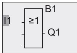
Pressez OK. I1 est maintenant connecté à l'entrée du bloc OR. Le curseur se positionne sur l'entrée suivante du bloc OR.
