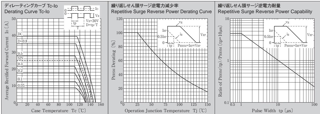
\* Sine waveは50Hzで測定しています。
