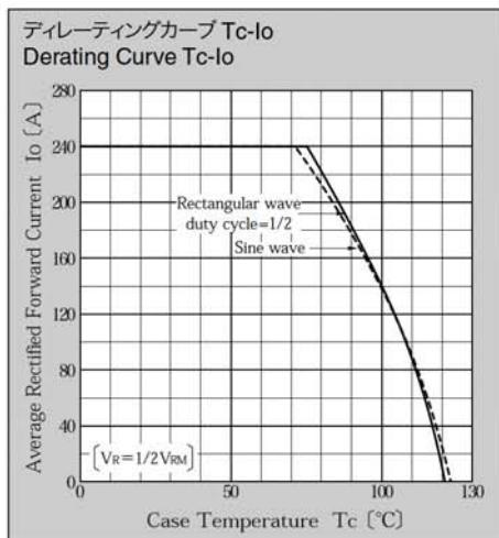
\* Sine waveは50Hzで測定しています。
