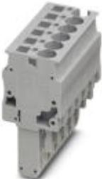
Stecker, Anschlussart: Zugfederanschluss, Polzahl: 1, Querschnitt: 0,08 mm<sup>2</sup> - 6 mm<sup>2</sup>, AWG: 28 - 10, Breite: 6,2 mm, Höhe: 41,5 mm, Farbe: blau
