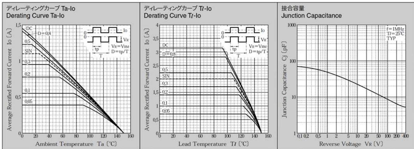
\* Sine waveは50Hzで測定しています。
