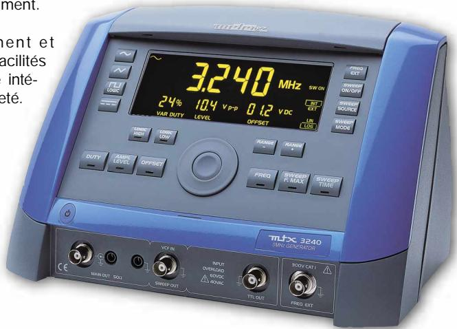
Les MTX 3240 et MTX 3250 sont disponibles en version programmable par l'intermédiaire d'une interface RS232 optique rapide et isolée, garantissant une sécurité complète de l'utilisateur et des équipements associés.
