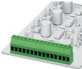
Leiterplattenklemme, Nennstrom: 24 A, Nennspannung: 400 V, Rastermaß: 5 mm, Polzahl: 3, Anschlussart: Schraubanschluss, Montage: Löten, Anschlussrichtung Leiter/Platine: 0 °, Farbe: grün, Der Artikel ist zu unterschiedlichen Polzahlen anreichbar!
