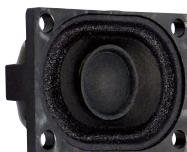
2,8 x 4 cm (1,1" x 1,6") Kleinlautsprecher mit Papiermembran und rechteckigem Kunststoffkorb. Geringe Baugröße aufgrund des Neodymantriebs. Durch das hervorragende Zusammenspiel der unterschiedlichen Komponenten wird ein sehr lineares Übertragungsverhalten erreicht. Der Anschluss erfolgt über rückseitig angebrachte Lötstellen.
