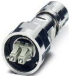
LWL-Steckverbinder LC, IP67, mit Bajonett-Verriegelung, Metallgehäuse, duplex, mit Klebeanschlusstechnik, für Multimodefaser, für Kabeldurchmesser 5,0 mm ... 10 mm
