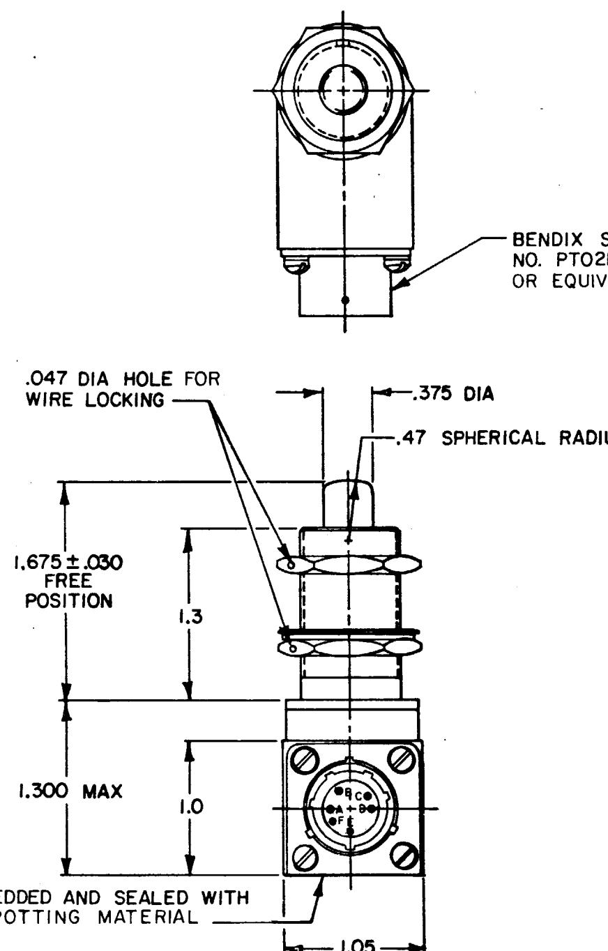
CORROSION RESISTANT STEEL PLUNGER
