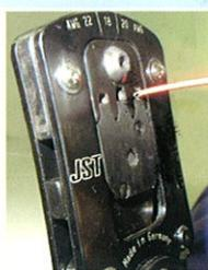
5. Bei der Entnahme des fertigen Kabels ist die Positioniereinrichtung etwas nach vorne zu ziehen, so dass sich das Kabel leichter entnehmen lässt.
