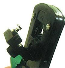
2. Schliessen Sie die Kabelschuh-Positioniereinrichtung, so dass der Kabelschuh in die richtige Lage innerhalb der Quetschbacken gebracht wird. Isolieren Sie nun ein Kabel in der empfohlenen Länge ab.
