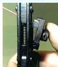
6. Falls das Werkzeug vor der Durchführung des Crimpvorganges aufgrund einer falschen Kabelschuh-Positionierung geöffnet werden muss, kann die Ratsche gelöst werden, indem Sie gegen den Freigabehebel drücken.
