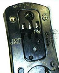
3. Überprüfen Sie die Übereinstimmung des Kabelquerschnitt mit dem zu verwendeten Crimpkontakt. Führen Sie das Kabel in die entsprechende Öffnung des Werkzeuges bis zum Kabelanschlag ein.
