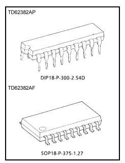
Weight DIP18-P-300-2.54D: 1.47 g (typ.) SOP18-P-375-1.27: 0.41 g (typ.)
