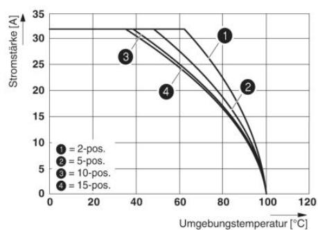
Abbildung zeigt die Deratingkurve der Klemme UT 4/1P... in Verbindung mit dem Stecker UPVB 4
