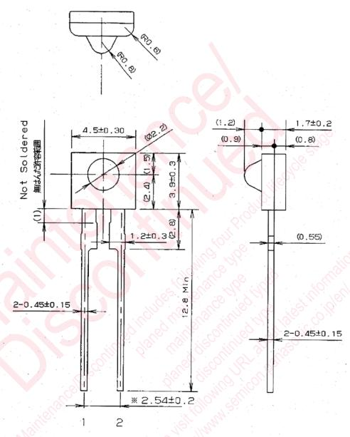
(注 1)※リード根元寸法とする。 (Note1)※Indicates root dimensions of lead.
