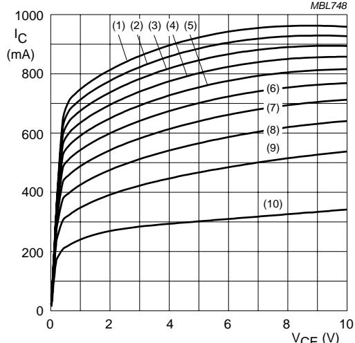
(1)  $I_B = 15$  mA. (5)  $I_B = 9$  mA. (9)  $I_B = 3$  mA.
