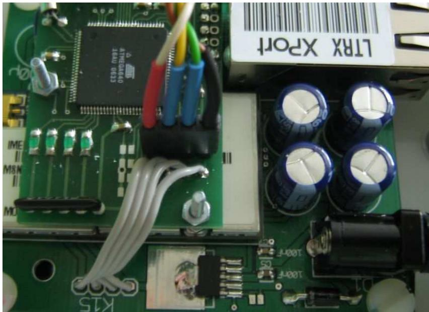
Das Konfigurationskabel hat einen Verpolungsschutz: Wenn man es falsch verkehrt herum anschließt entsteht kein Schaden.
