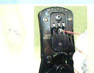
4. Der Crimpvorgang wird ausgeführt, indem Sie die Werkzeuggriffe vorsichtig zusammendrücken. Sobald die Crimpbacken vollständig ineinander fassen, wird die Ratsche automatisch gelöst und das Kabel mit dem angeschraubten Kabelschuh kann entnommen werden.
