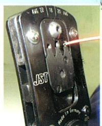
5. Bei der Entnahme des fertigen Kabels ist die Positioniereinrichtung etwas nach vorne zu ziehen, so dass sich das Kabel leichter entnehmen lässt.
