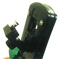
2. Schliessen Sie die Kabelschuh-Positioniereinrichtung, so dass der Kabelschuh in die richtige Lage innerhalb der Quetschbacken gebracht wird. Isolieren Sie nun ein Kabel in der empfohlenen Länge ab.
