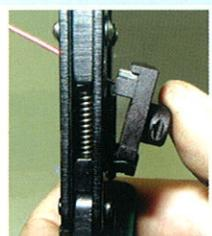
6. Falls das Werkzeug vor der Durchführung des Crimpvorganges aufgrund einer falschen Kabelschuh-Positionierung geöffnet werden muss, kann die Ratsche gelöst werden, indem Sie gegen den Freigabehebel drücken.
