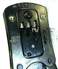
3. Überprüfen Sie die Übereinstimmung des Kabelquerschnitt mit dem zu verwendeten Crimpkontakt. Führen Sie das Kabel in die entsprechende Öffnung des Werkzeuges bis zum Kabelanschlag ein.
