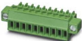
Steckerteil, Nennstrom: 8 A, Bemessungsspannung (III/2): 160 V, Polzahl: 18, Rastermaß: 3,5 mm,
