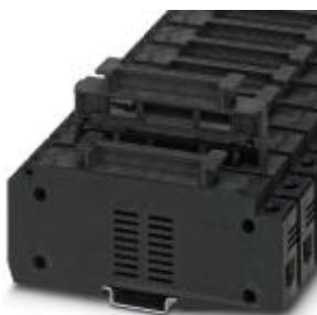
Sicherungsreihenklemme, Anschlussart: Schraubanschluss, Querschnitt: 1,5 mm<sup>2</sup>- 25 mm<sup>2</sup>, AWG: 18 - 3, Nennstrom: 32 A, Nennspannung: 1250 V, Breite: 23 mm, Sicherungstyp: gG / gPV / 10,3 x 85, Montageart: NS 35/7,5, NS 35/15, Farbe: schwarz
