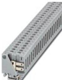
Durchgangsklemme, Anschlussart: Flachsteckanschluss, Querschnitt: 0,5 mm<sup>2</sup> - 1 mm<sup>2</sup>, AWG :20-18, Breite: 5,2 mm, Farbe: grau, Montage: NS 15
