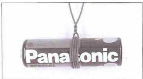
Slika 5.2.: navijanje sklopne tuljave
